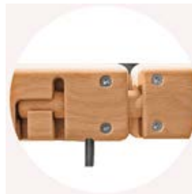
Patentsluiting IV: De labyrint sluiting voorkomt het onbedoeld openen van de deurtjes en heeft als extra een veer waardoor de schoot altijd „ onder druk „ staat.
